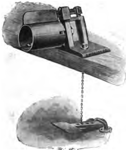
Machine Bliss à souder les agrafes.
